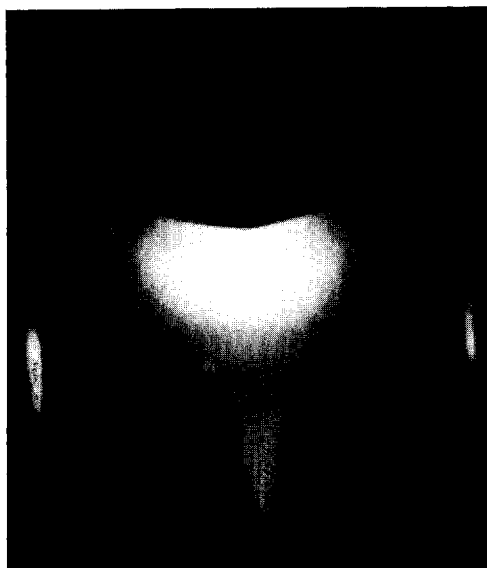
FIG. 8. Diagramme de diffraction électronique d'un monocrystal de chrome d'orientation (100) polarisé pendant 15 hr à -100 mV dans une solution d'acide sulfurique 1 N.
